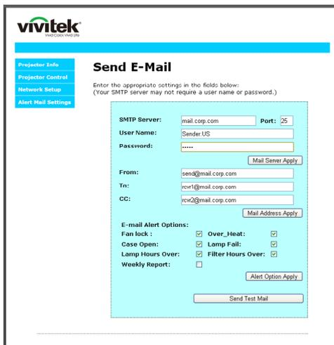
注意: 依說明填入所有欄位。使用者可按一下傳送測試郵件以測試正確的設定。若要成功傳送電子郵件通知, 您必須選擇通知情況並輸入正確的電子郵件地址。
