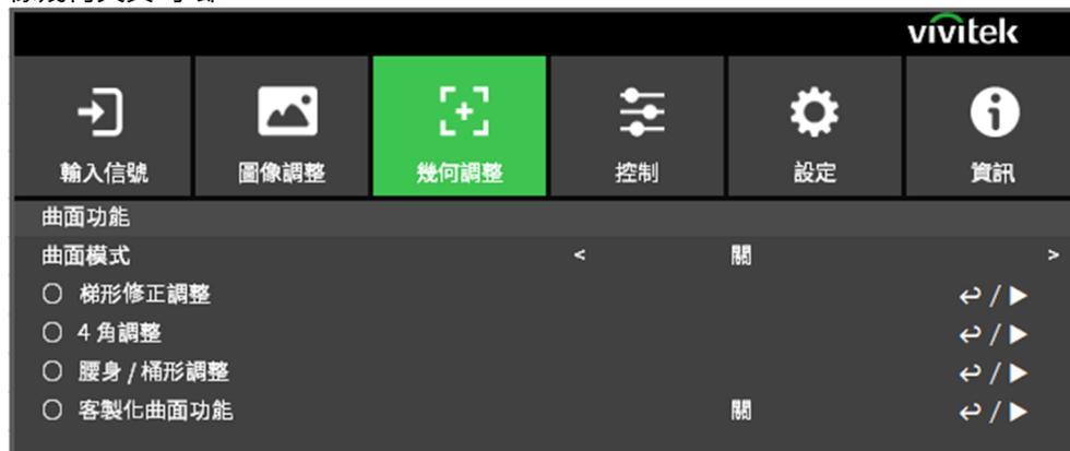
**曲面模式：**可選擇 4 種模式：梯形修正調整、4 角調整、腰身 / 桶形調整和客製化曲面功能。
